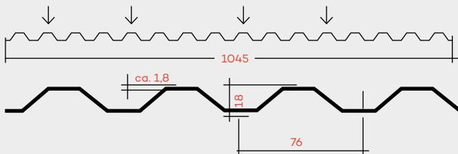
Querschnitt der PLEXIGLAS® Resist TP 76/18/1,8 (Maße in mm)
